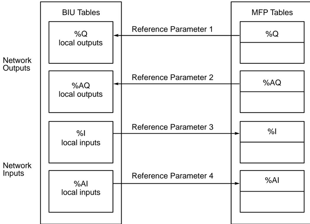
Figure 3-2. Reference Parameter Mapping for Example 1
