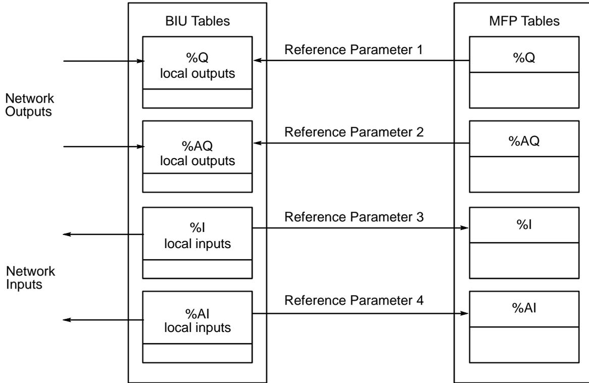
Figure 3-6. Reference Parameter Mapping for Example 3
